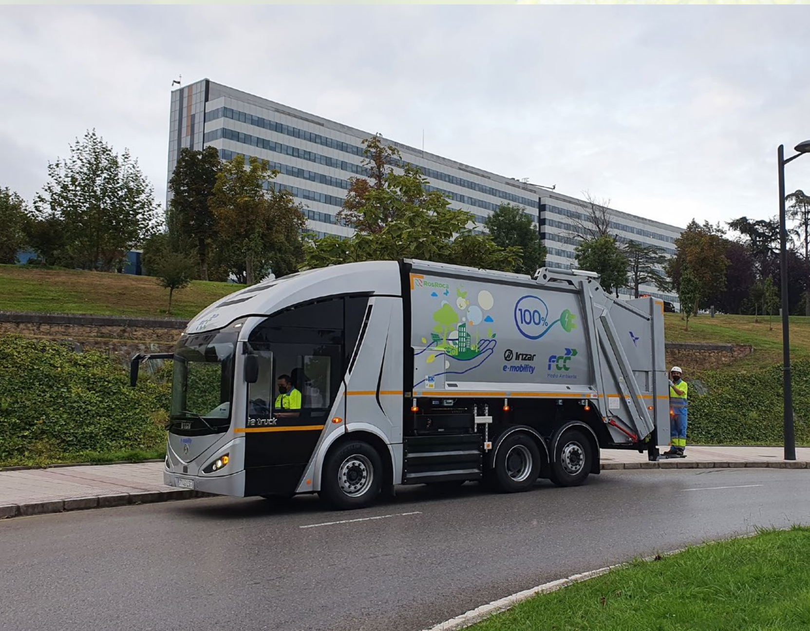
Ie-Urban truck: vehículo recolector eléctrico de carga trasera desarrollado sobre la plataforma de e-movilidad de FCC Medio Ambiente.
